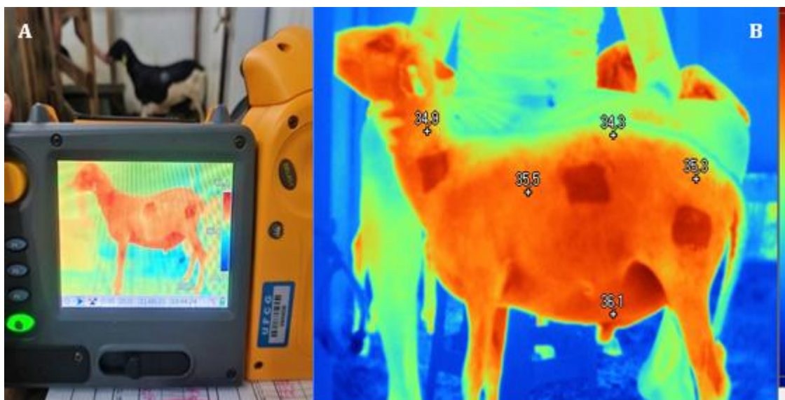
Figura 04: Termografia de infravermelho de ovino em câmara climática (câmera termográfica Fluke®Ti55FT) (A) e termograma analisado no Smartview versão 4.1 (B) (Fonte: arquivo pessoal, 2021).
