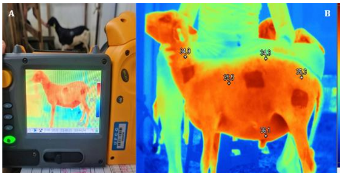
Figura 04: Termografia de infravermelho de ovino em câmara climática (câmera termográfica Fluke®Ti55FT) (A) e termograma analisado no Smartview versão 4.1 (B) (Fonte: arquivo pessoal, 2021).
