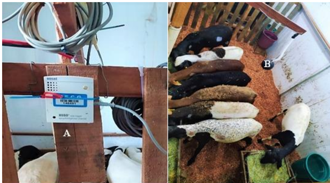
Figura 03. Datalogger tipo HOBO (A), e cabo externo com os sensores acoplados ao globo negro próximo à altura dos animais na área central da baia (B). (Fonte: arquivo pessoal, 2021).
